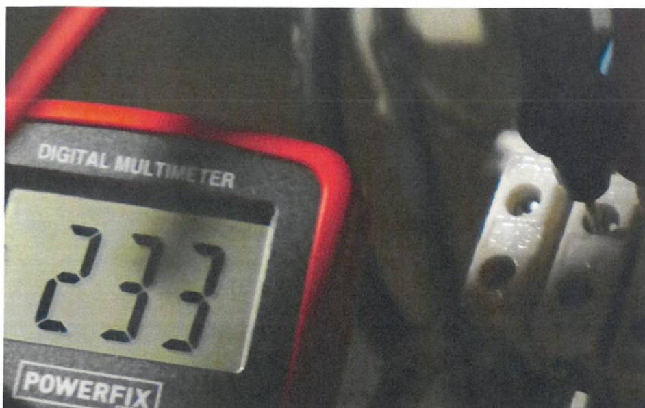
In buona sostanza il sistema di alimentazione è lo stesso da quello proposto in progetto con unica differenza ci sono tre morsetti esposti agli agenti atmosferici senza nessun tipo di isolamento. Tale situazione è alquanto pericolosa, come mostra la misurazione fatta in corrispondenza del numero 9 di Via Daldini.
